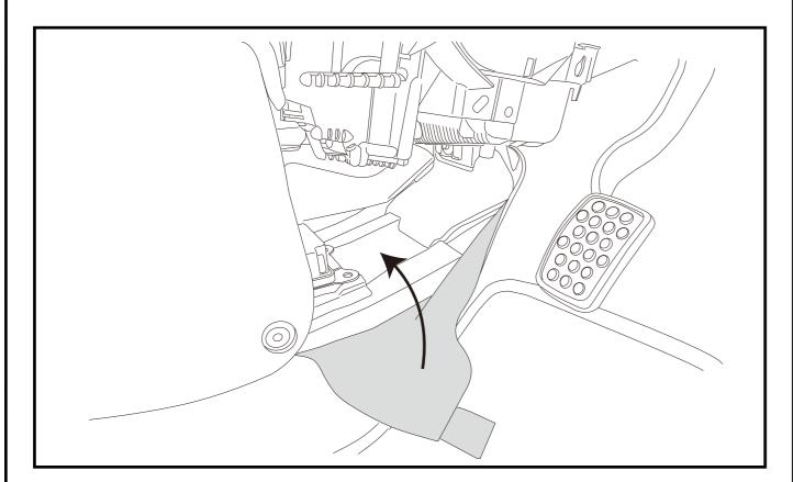
4. 元に戻した運転席側のフロアカーペットを押さえ、エアバックコントローラーの右側の穴部分にカッターナイフなどを使用して、ボルトが通るサイズの穴を開けます。 ※穴を開けるのは運転席側のフロアカーペットのみです。
