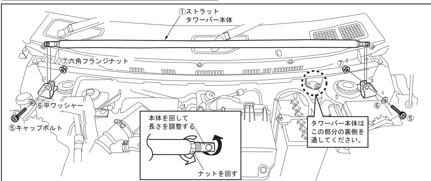
4. 図を参照して、①ストラットタワーバー本体を②アッパー ブラケットの穴位置に合わせてセットしてください。
